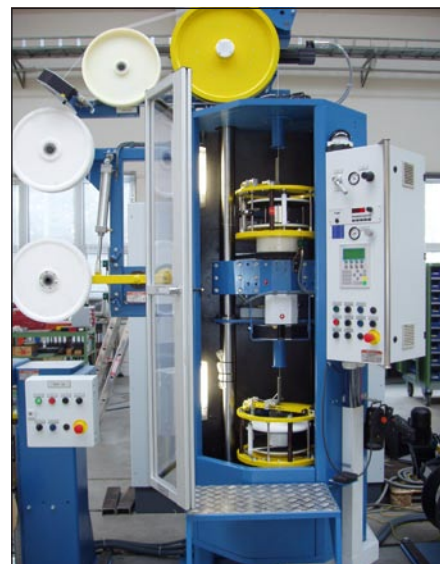
Fot. 2. Widok systemu izolującego. Przewód jest przeciągany przez maszynę od dołu do góry i dokonuje się wtedy proces izolacji
